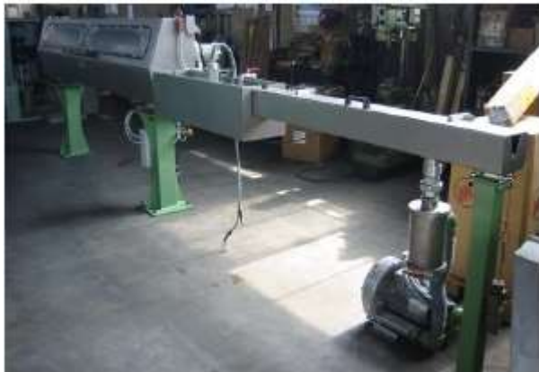
Canal de enfriamiento
