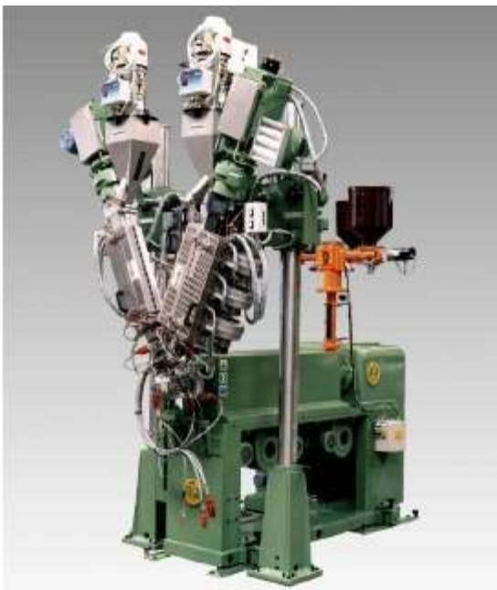
Grupo di estrusori linea polivalente per cavi LAN
