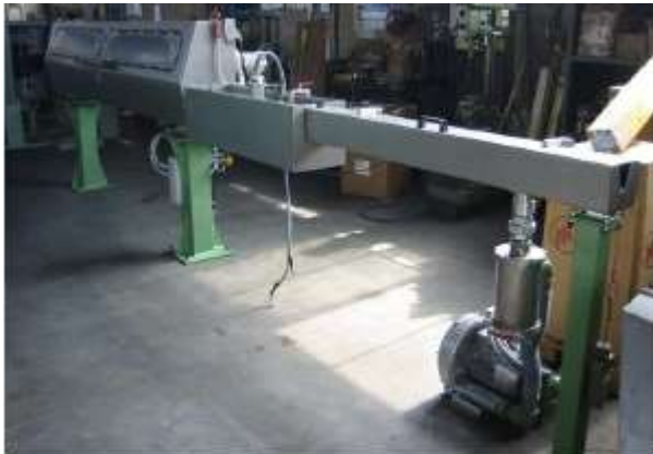
Canal de enfriamiento Micro-coaxial
